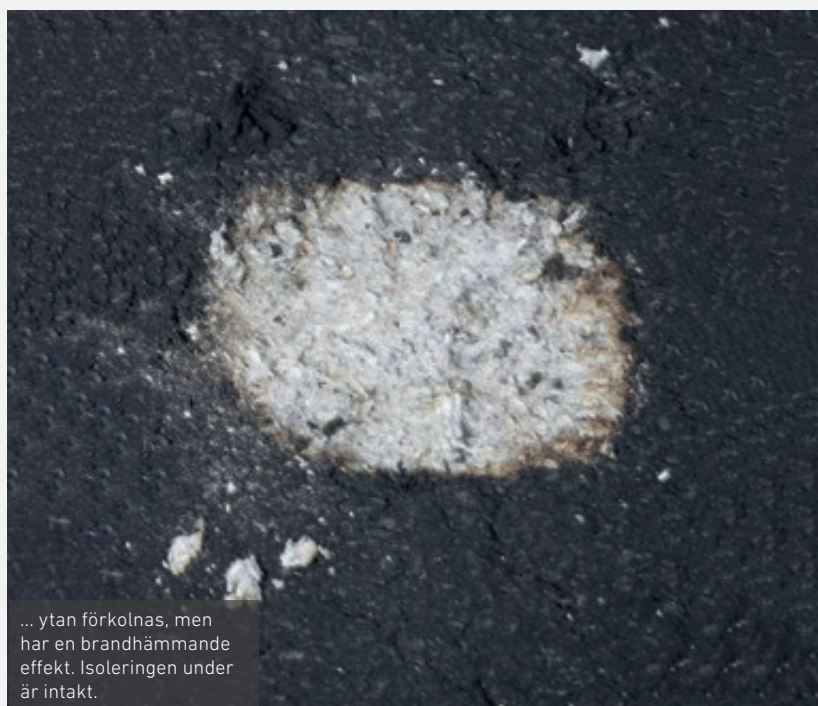
Cellulosaisolering brinner som trä, kontrollerad men säkert. I en visning behandlas cellulosa vid 1000 ° C i flera minuter.
